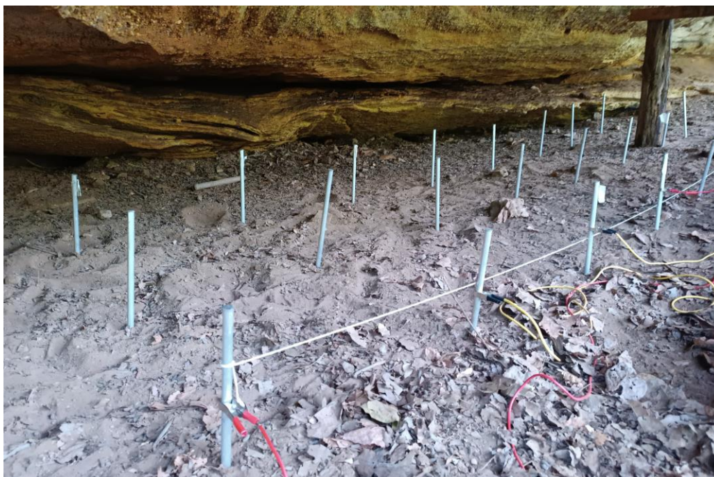
Figura 7: A porção central do abrigo e o detalhe dos eletrodos durante a coleta de dados nas linhas L4, L5 e L6. Fonte: Acervo do Laboratório de Preservação Patrimonial.
