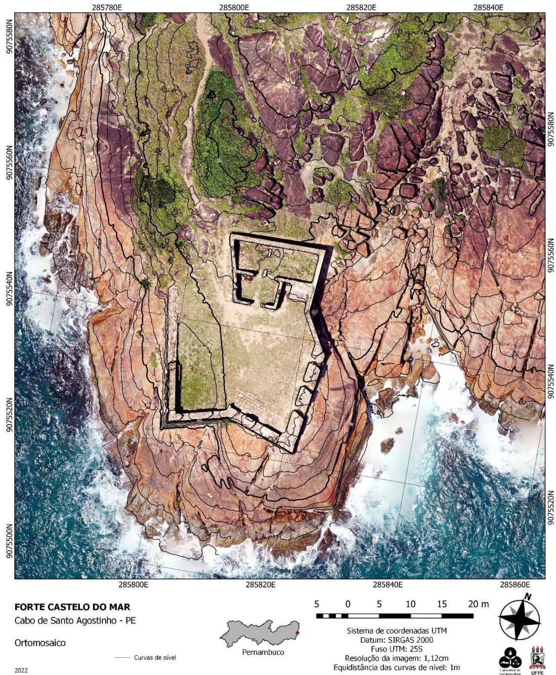
Figura 17: Ortomosaico para a área de detalhe do Forte Castelo do Mar. Fonte: GEAGT-UFPE, 2022.
