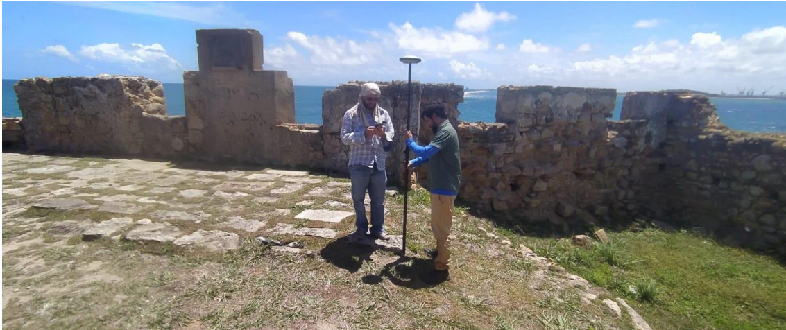
Figura 9: Plotagem do ponto A sem alvo, porém, utilizando-se da própria estrutura presente na fortificação. Fonte: Siqueira, 2022.
