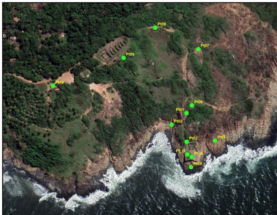
Figura 10: Pontos de controle plotados com o auxílio de receptor GNSS RTK. Fonte: Silva, 2022.
