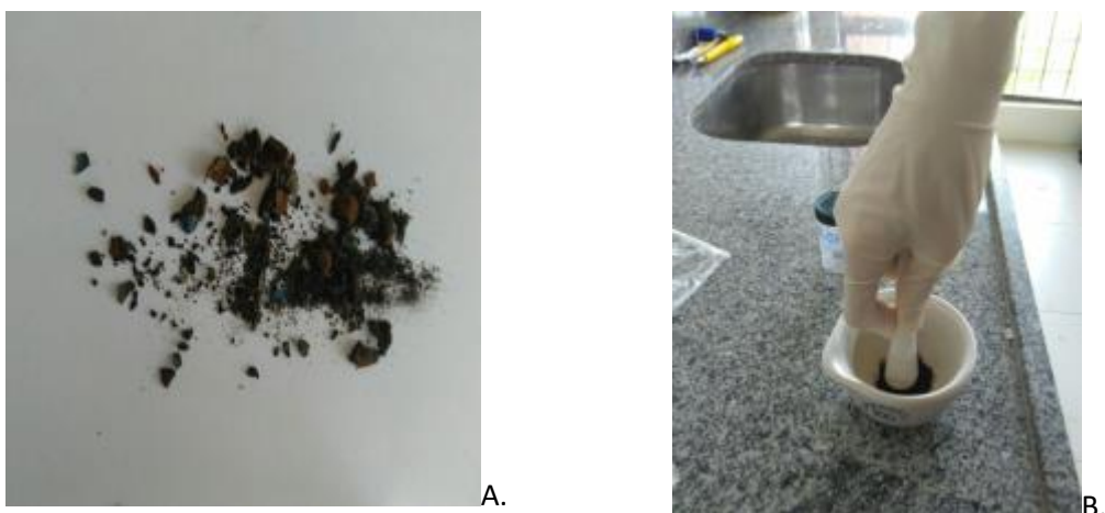
Figura 6 - A. Seleção manual de amostra; B. Processo de trituração para preparo de amostra. Fonte: Acervo Pessoal.
