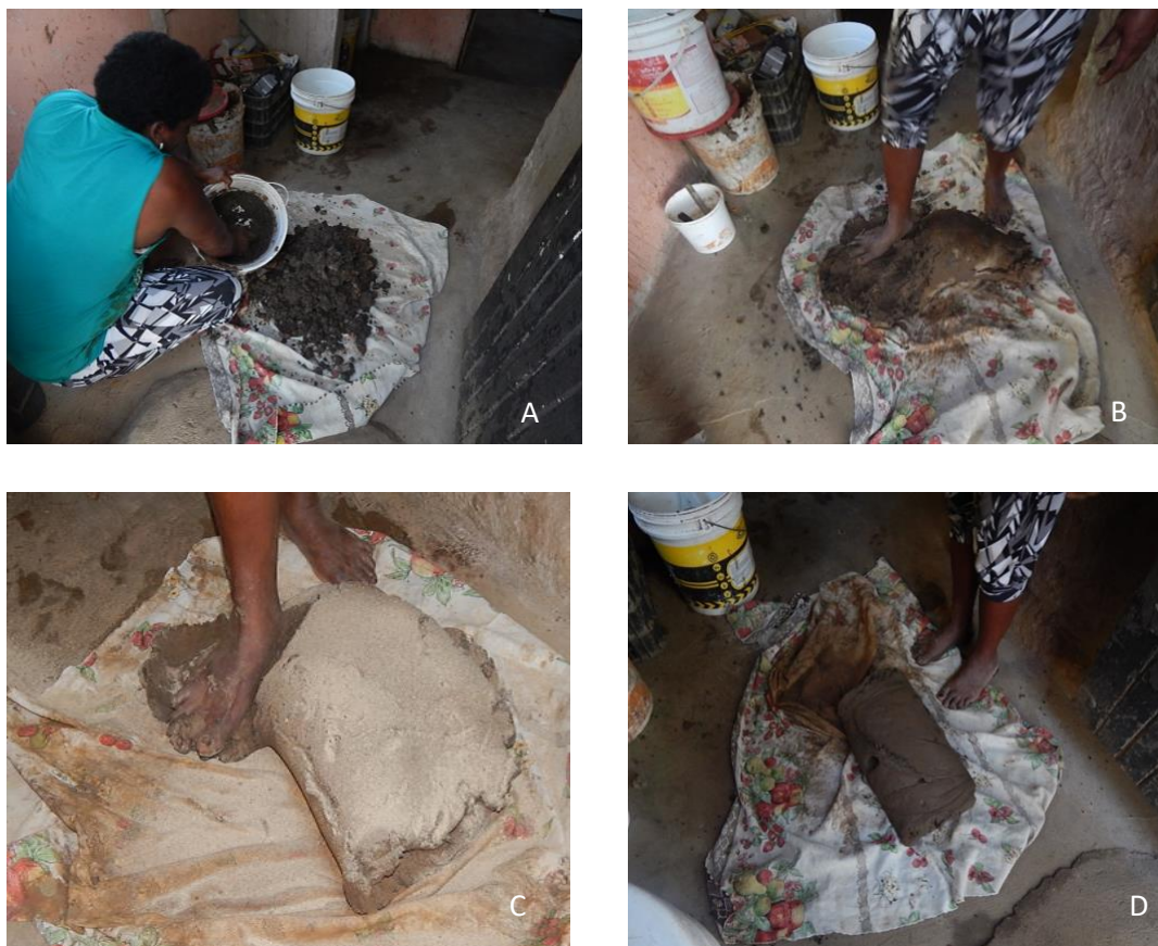
Figura 4: molhando a argila (A), começo do processo de amassar (B), colocação de aditivo ou areia como antiplástico (C), pasta pronta (D). Fonte: Elizânia Vicente, 2015.
