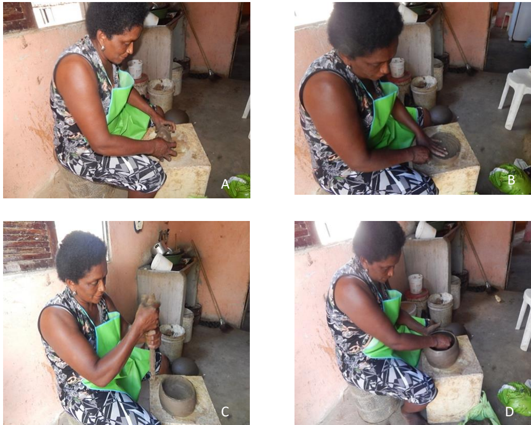
Figura 5: “bola” de argila (A), modelagem do disco (B), rolete espiralado (C), alisamento da peça (D). Fonte: Elizânia Vicente, 2015.
