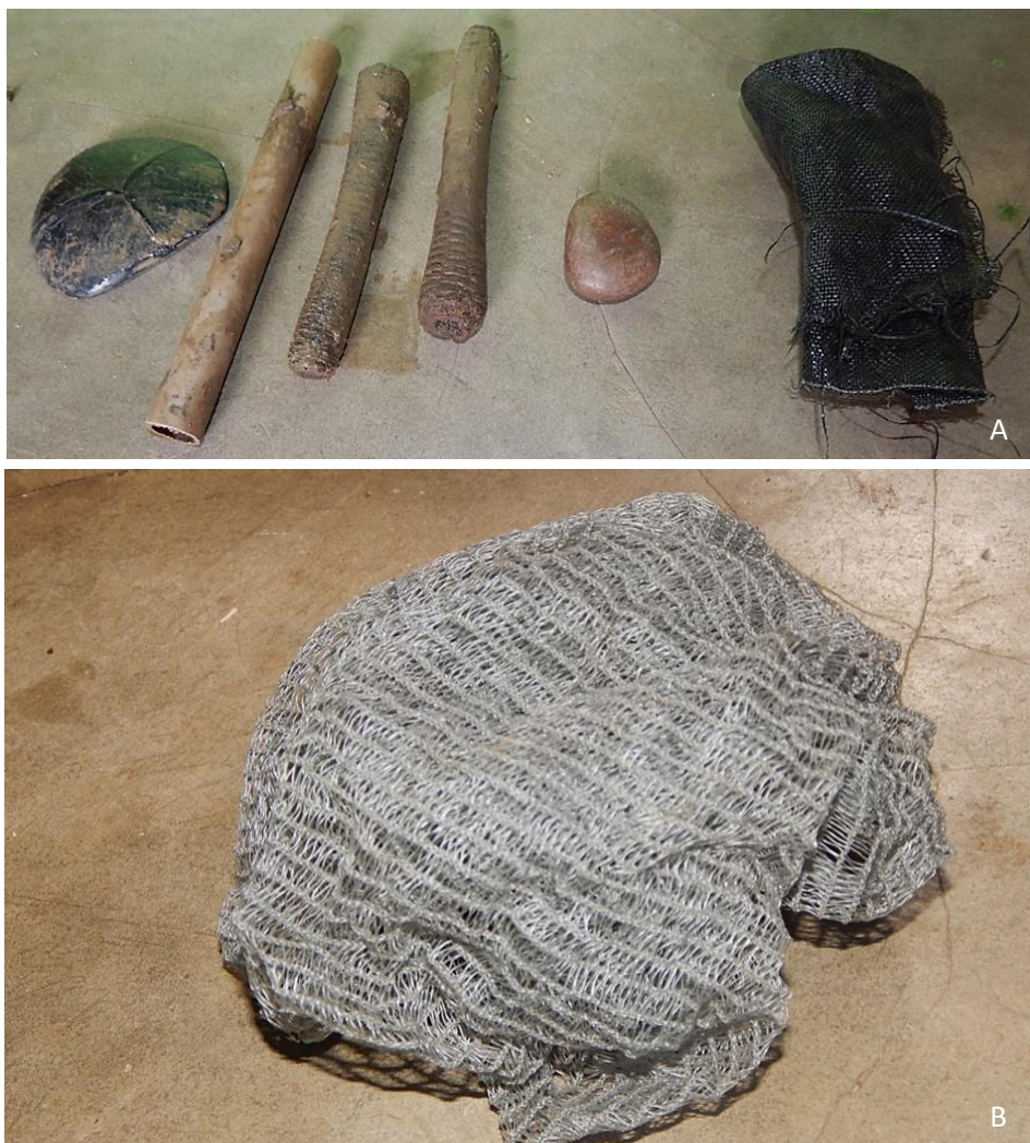
Figura 8: materiais usados na produção da cerâmica, a saber: “quenga” de coco, tubo plástico, vegetal (sabugo de milho) (A), pano e tela de material sintético (B). Fonte: Elizânia Vicente, 2015.
