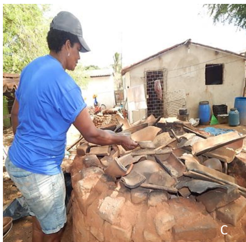
Figura 9: forno (A), alimentação da chama (B), cobertura do forno com cacos de telhas e vasilhas quebradas (C), peças prontas (D). Fonte: Elizânia Vicente, 2015.
