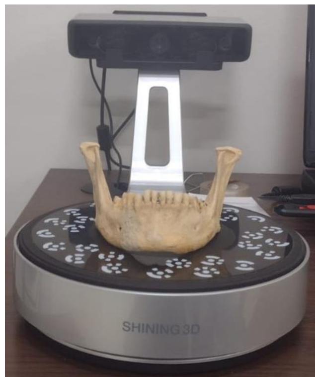
Figura 4: Exemplo de escaneamento de um crânio do sítio Pilar, para captação da mandíbula pelo scanner 3D.
